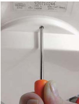
1 - Coupez l'alimentation électrique du chauffe-eau, puis dévissez les vis du capot.
