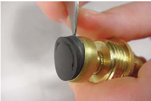
3 - Retirez le clapet enchâssé dans la coupelle en laiton avec la pointe d'un couteau.
