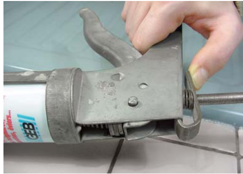
4 - À la fin, débrayez en appuyant à l'arrière.
