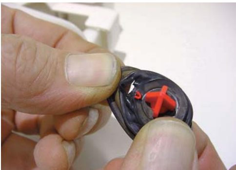
3 - La membrane est déchirée, remplacez-la.
