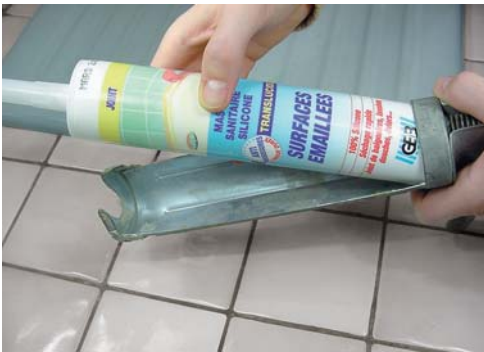
2 - Installez la cartouche dans le pistolet.
