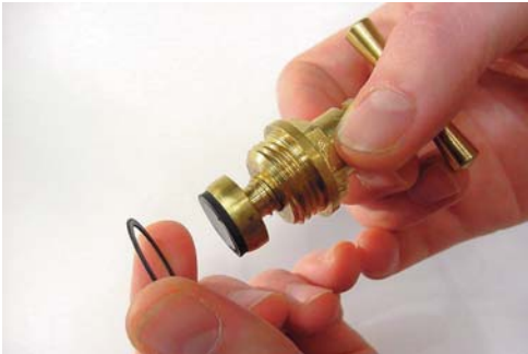
2 - Retirez la tête, enlevez le joint d'étanchéité, à remplacer par un neuf lors du remontage.
