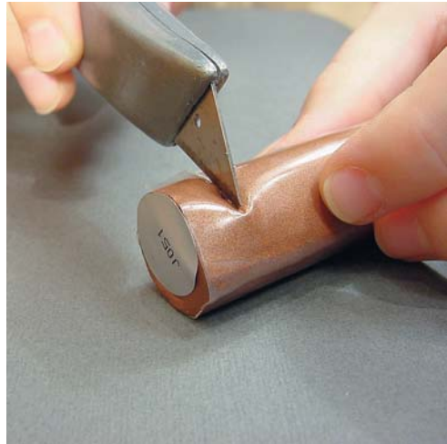
3 - Découpez une tranche de mastic bicomposant de 1 cm d'épaisseur environ.
