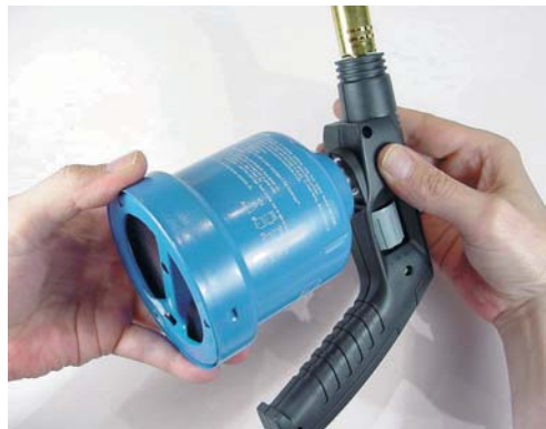
3 - Vissez le chalumeau pour percer la cartouche.
